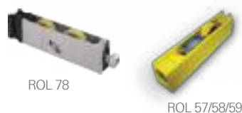
COM REGULAGEM ROL 57 Roldana s/ rolamento 15kg - janela ROL 58 Roldana c/ rolamento 30kg - janela ROL 59 Roldana c/ rolamento 40kg - porta ROL 78 Roldana c/ rolamento 60kg - porta
