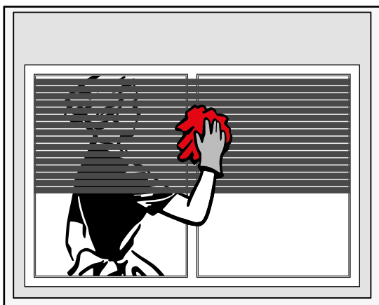
1) Limpe pelo lado externo somente as primeiras palhetas utilizando um pano úmido.
