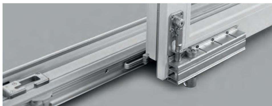
Na roldana, a folha pode ter o ajuste de altura executado entre -2 e +6 mm. Assim, evita-se a alteração dos trilhos em folhas leves. O ajuste ativo de altura das roldanas de rolamentos por meio de roscas faz com que a elevação ou a liberação da folha seja desnecessária.
