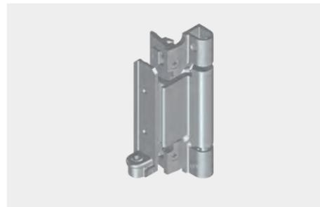
Reforço para o sortimento universal Roto AL 540 de janelas e porta janelas de alumínio até 300 quilos: um novo sistema de dobradiça para folhas giratórias com até 160 quilos. Ele possibilita a fabricação de folhas na altura do espaço até 2.700 mm de altura e destaca-se especialmente pelo seu braço de compasso dobrado confortável com ajuste lateral integrado.
