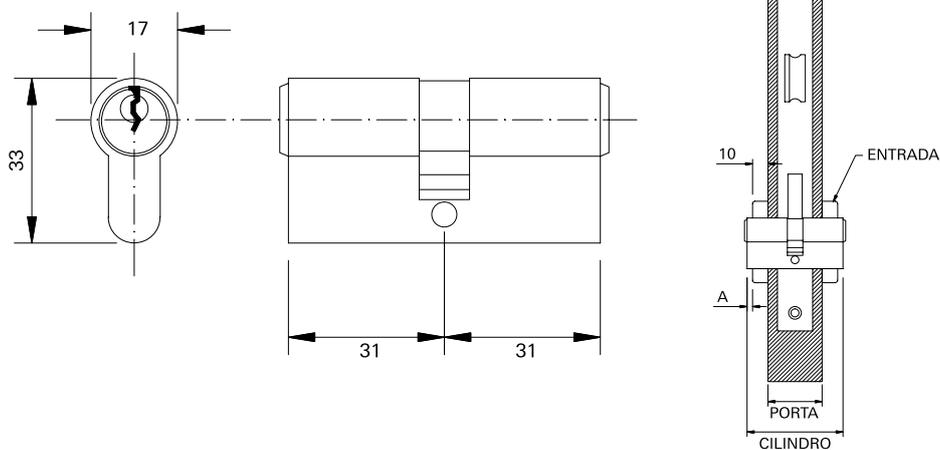
**Aplicação do Cilindro x Espessura da Porta**
